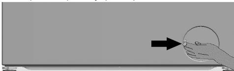
3. Некоторые модели оснащены шлангом аварийного слива воды. Чтобы слить воду из машины, выполните описанные ниже действия.
