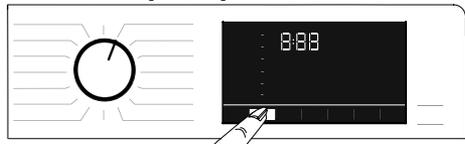
При выборе программы на индикаторе скорости отжима отображается скорость отжима, рекомендованная для данной программы. Возможно, что скорость отжима, рекомендованная для данной программы, не является для нее максимальной. Если нужно снизить скорость отжима, нажмите кнопку регулировки скорости отжима: скорость отжима будет постепенно уменьшаться. После этого в зависимости от модели машины на дисплее отобразятся функции «Задержка полоскания» и «Без отжима».
