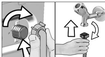
2. После подсоединения шлангов полностью откройте краны для проверки мест подсоединения на наличие протечек. В случае протечки закройте кран и отвинтите гайку. Проверьте прокладку и тщательно затяните гайку еще раз. Во избежание возможных протечек и связанного с этим ущерба закрывайте краны, когда машина не используется.
