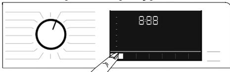
При выборе новой программы на индикаторе температуры отображается рекомендованная температура для данной программы. Возможно, что температура, рекомендованная для данной программы, не является для нее максимальной. Если нужно понизить температуру, нажмите кнопку выбора температуры: температура будет постепенно понижаться.
