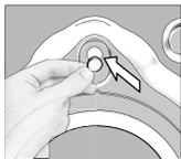
Закройте отверстия на задней стенке пластиковыми заглушками, которые находятся в пакете с инструкцией по эксплуатации.
