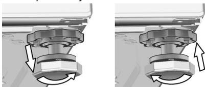
3. Затем вручную затяните все контргайки.
